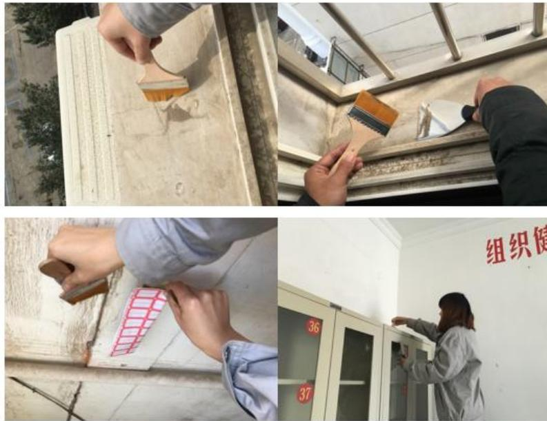
图 3 混合扬尘样品采集现场
